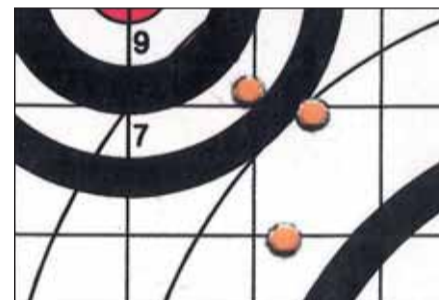
Přesnost zbraně Brno 602 ovlivnilo ohřátí hlavně, které se projevilo již po dvou výstřelech.
