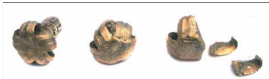
Střely vystřelené do simulátoru při různých rychlostech. Vlevo .308 Win tovární nabití při počáteční rychlosti 789 m/s, uprostřed .300 WSM 905 m/s a vpravo .300 WSM 928 m/s.
